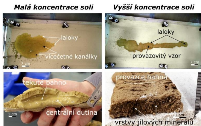
Obrázek 4: Ukázka některých tvarů bahenních proudů pro odlišné koncentrace soli (konkrétně se jedná o \text{MgSO}_4 a koncentrace 0,5 % a 10 %). S vyšším obsahem soli se zvyšuje dosah proudů, ale mění se i způsob toku a tvar proudů.
